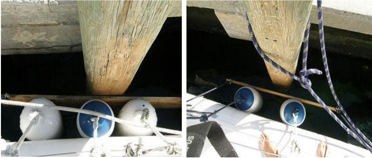
Unsere Fender mit den Fenderbrettern an den Holzpfählen am Steg.
